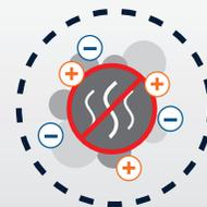
Geruchsgase und Aerosole oxidieren bei Kontakt mit Sauerstoffionen und werden neutralisiert.
