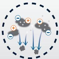
Luftpartikel werden durch Ionen aufgeladen, wodurch sie sich sammeln und in Cluster verbinden. Durch das höhere Gewicht sinken die Teilchen dann in der Luft zu Boden.
